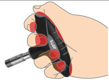
Der T - Handgriff wird benötigt, wenn besonders hohe Drehmomente zu lösen oder festzuziehen sind.
