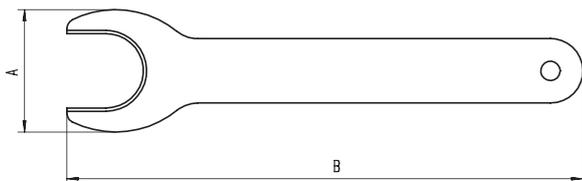
Das Werkzeug zur Demontage ist hilfreich, die Reduzierhülse aus dem Werkzeughalter zu entfernen.
