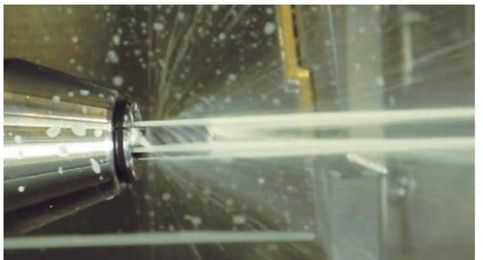
Verwendung der Reduzierhülse HS-CF - zur periphere Kühlung.
