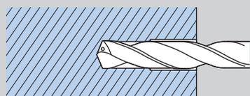
④ Nach dem Bohren das Werkzeug vom Grund abheben, danach die Drehzahl auf 500 bis 1000 min<sup>-1</sup> (n) reduzieren und aus der Bohrung ausfahren.
