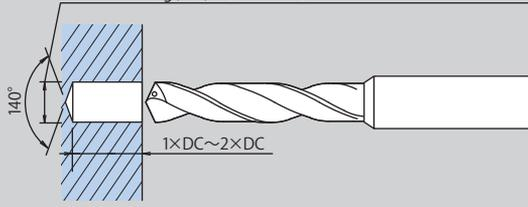
★ Bitte verwenden Sie bei gekrümmten Oberflächen, vor dem Bohren der Pilotbohrung den ADF (VHM Flachbohrer) zum Anbringen einer Fläche.
