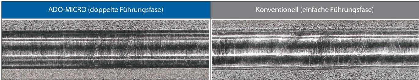
Werkzeug: ADO-MICRO 20D Ø 2 Material: 1.4301 Bohrtiefe: 40mm
