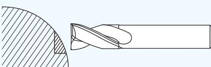
② Einfahren mit dem Tieflochbohrer in die Pilotbohrung mit reduzierter Drehzahl von 500 bis 1,000 min<sup>-1</sup> (n).
